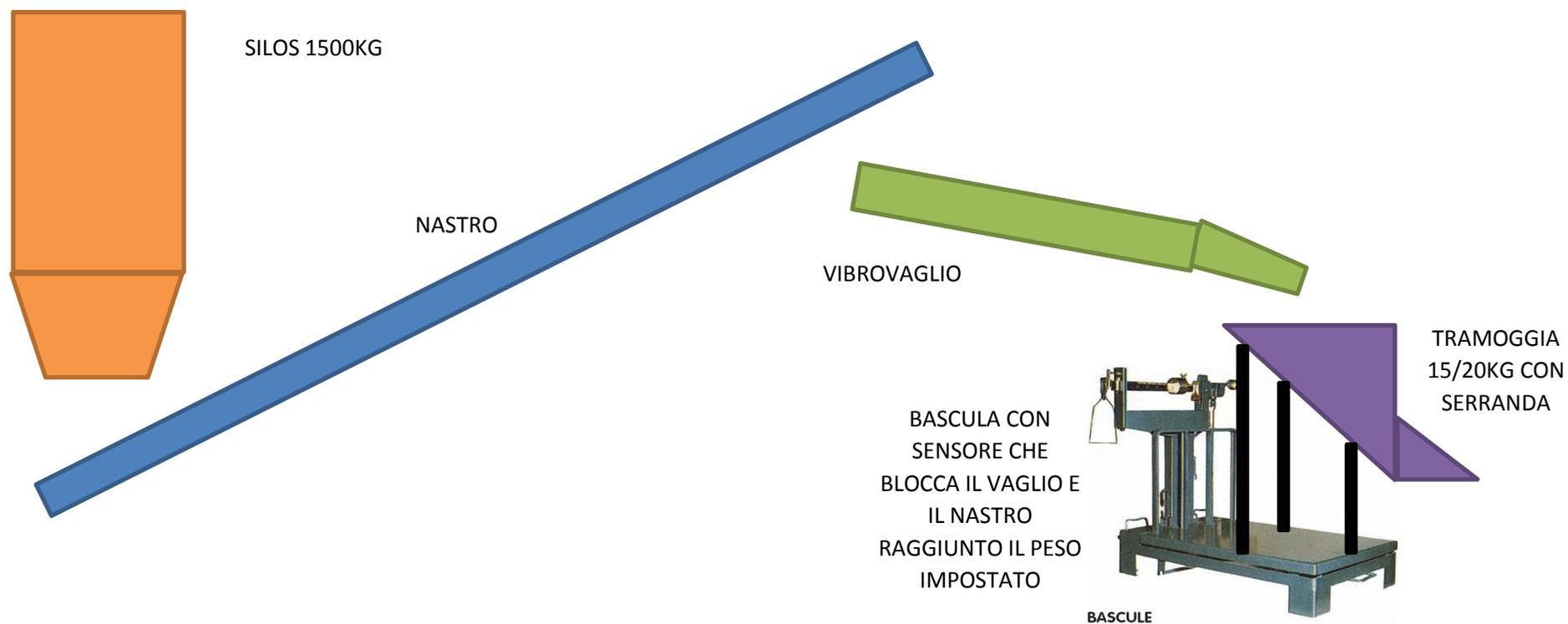
AL RAGGIUNGIMENTO DEI 15 KG IL VAGLIO E IL NASTRO SI FERMANO IN AUTOMATICO. SVUOTATA LA TRAMOGGIA IN CIRCA 5 SECONDI E RIEMPITO IL SACCHETTO CHIUDO LA SERRANGA E PREMO LO START E IL SISTEMA RIPARTE E PREPARA ALTRI 15 KG MENTRE IO SALDO IL SACCO E LO METTO SUL PALLET. PREPARANDO I 15 KG IN 30 O 40 SECONDI SI HA UNA PESATA PIÙ PRECISA E FERMANDOSI IN AUTOMATICO IO NON HO PERDITE DI TEMPO AD ASPETTARE LO RIEMPIMENTO...
