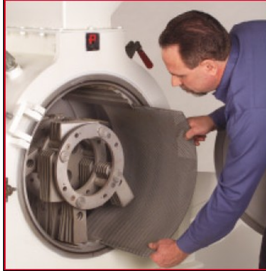
Figura 15: costruzione di un tritratore a lame.
