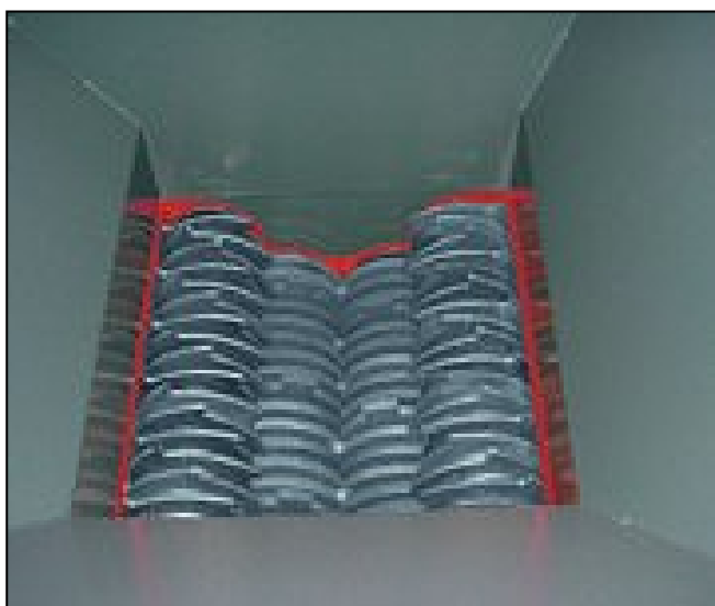
Figura 11: lame a disco dentato di un trituttore plurialbero.
