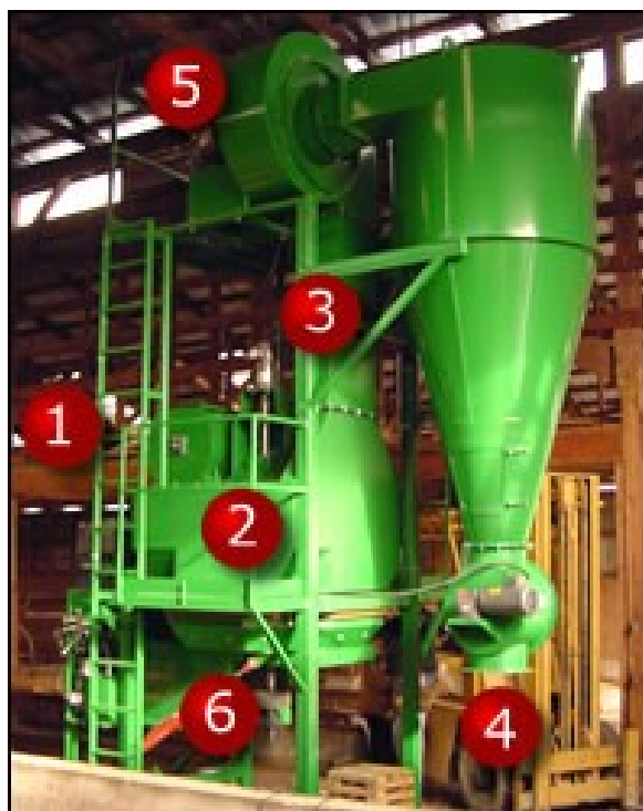
Figura 22: schema di impianto di un essiccatore – tritizzatore KDS Micronex. Il sistema di essiccazione presentato risulta essere decisamente vantaggioso rispetto ai metodi tradizionali.
