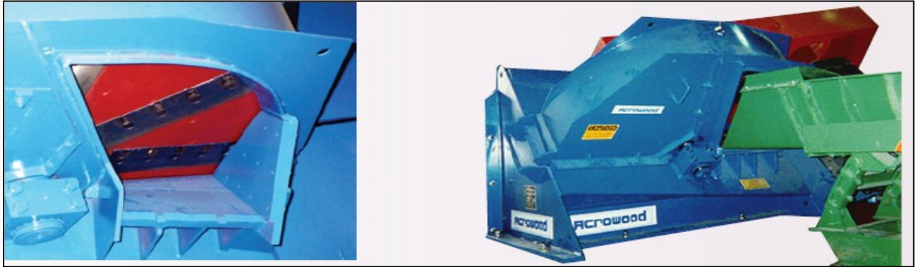
Figura 2: cippatrice a disco in costruzione fissa.
