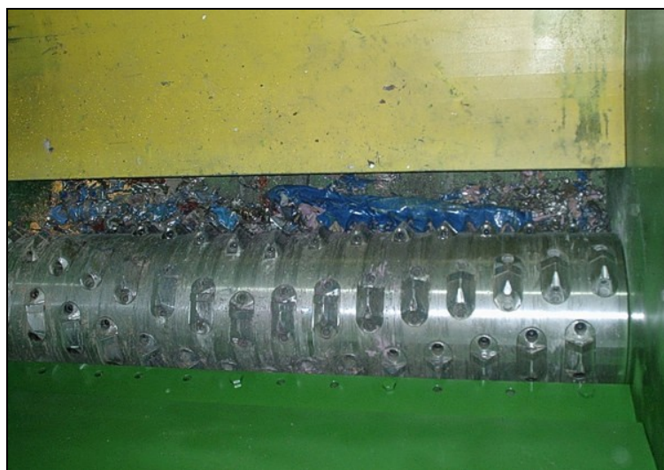
Figura 9: trituratore monoalbero, particolare del tamburo portautensili.
